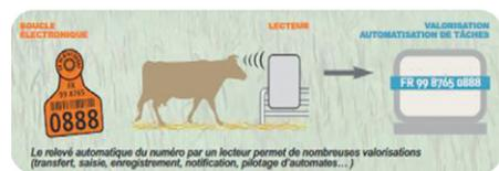
L'identifiant électronique officiel utilisé en France pour les bovins est une boucle, de forme similaire aux boucles conventionnelles, contenant un transpondeur ou puce électronique (RFID).
